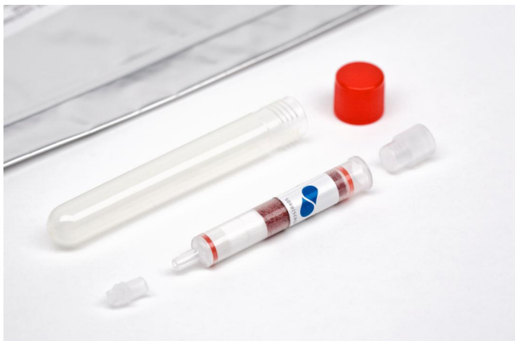
Billede 1. SorbiCell. Sorbicell'en indeholder et materiale, som kan adsorbere det stof (f.eks. nitrat), man er interesseret i at kende koncentrationen af. Cellen indeholder desuden et sporstof, der opløses proportionalt i det vand, der passerer cellen. Efter en periode fjernes cellen fra målestedet, og
